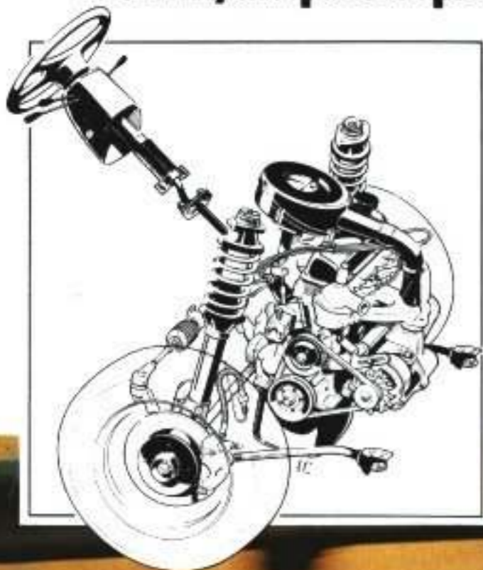
Die Frontantriebs Einheit des Ford Fiesta 5. Querstrommotor und McPherson Radaufhängung.
